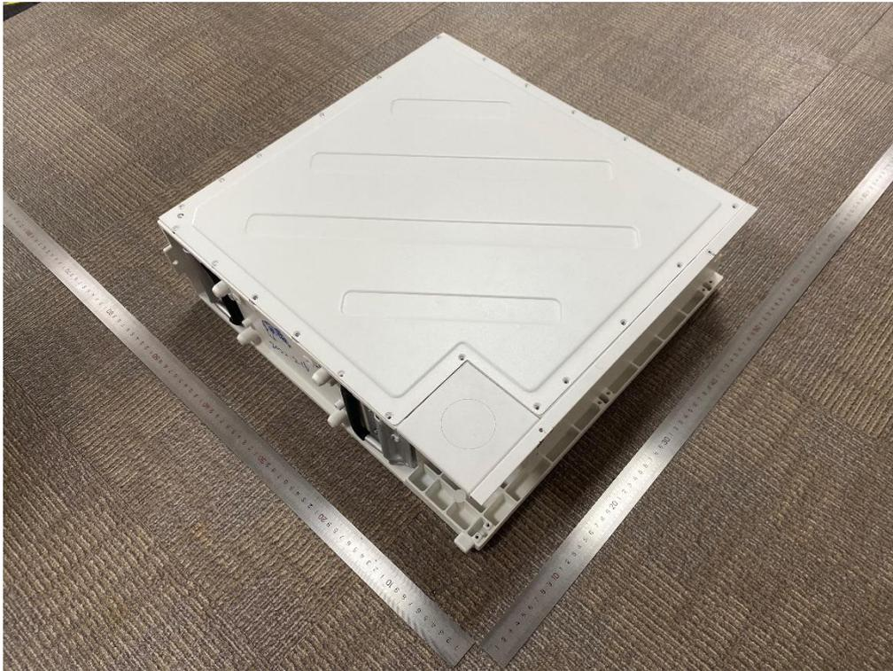
图 3 可充电锂离子电池模组背面
