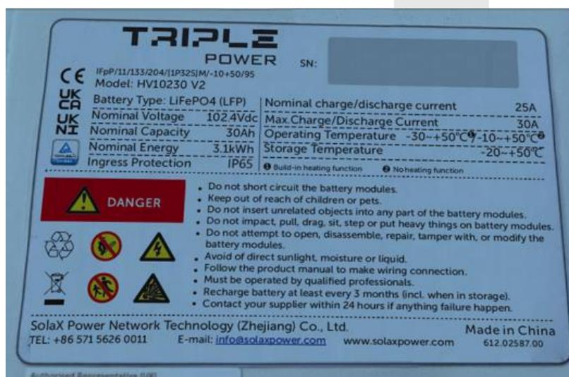
图 6 可充电锂离子电池模组标签
